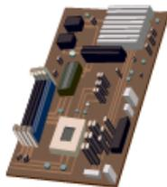
**Matična ploča (Motherboard)** središnji je dio sustavske jedinice i računala općenito. Ona objedinjuje i povezuje procesor i radni spremnik sa svim ostalim sklopovima i uređajima u jedinstvenu cjelinu.
