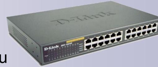
***Osnovna vrsta mrežnog uređaja je preklopnik (switch). Sastoji se od većeg broja utičnica u koje se utiču mrežni kablovi računala u mreži.***
